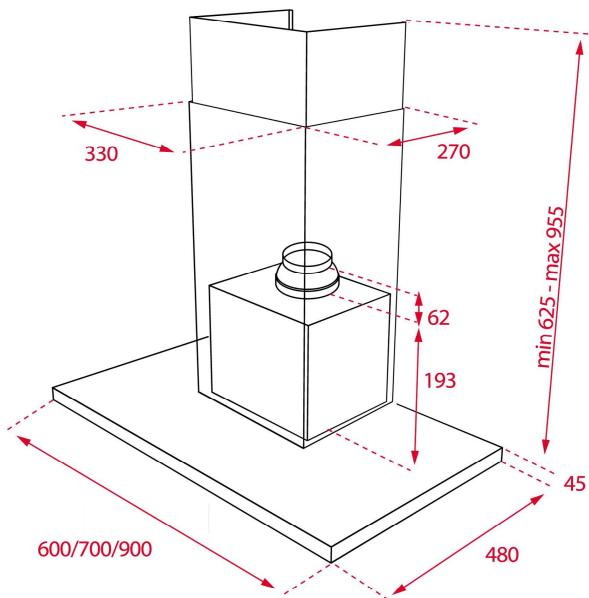
**DIMENSIONES****Altura del producto (mm):** 670-1000**Anchura del producto (mm):** 600**Profundidad del producto (mm):** 480**Longitud del producto (mm):****Peso neto (kg):** 13,37**ESPECIFICACIONES TÉCNICAS**
