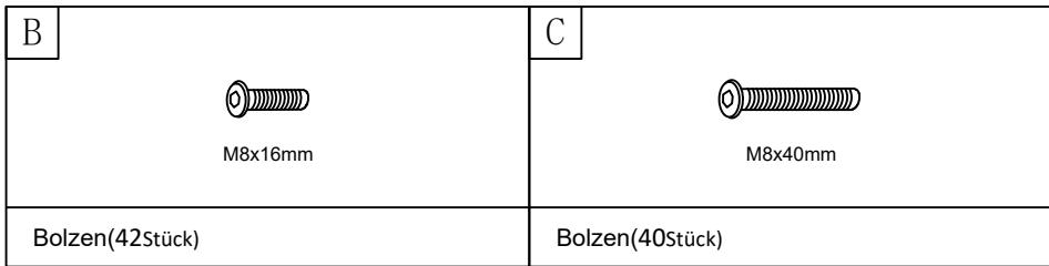
DE:Bitte beachten Sie, dass die Formen der Schrauben B und C ähnlich sind. Bitte installieren Sie entsprechend der Anleitung und unterscheiden Sie sie!
