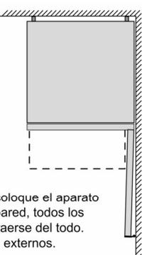
En caso de que se coloque el aparato directamente en la pared, todos los cajones pueden extraerse del todo.
