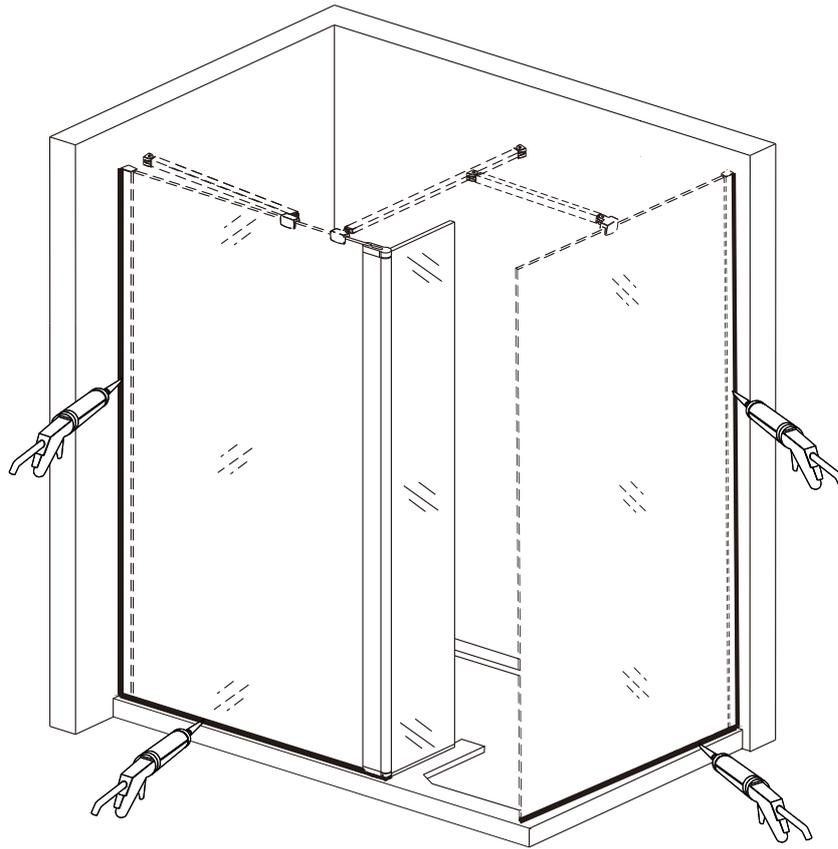
Aplicar silicona en el exterior del cuarto de ducha entre los perfiles y la pared; y entre el marco y el plato de ducha, para mejorar la impermeabilidad. Esperar 24hr después de aplicar silicona para usar.
