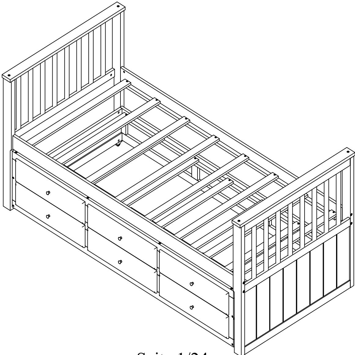
DE: Vor dem Einbau die Schrauben in die Löcher stecken und festziehen, aber nicht bis 100%, 70% bis 80% anziehen reicht aus. Schließlich, nachdem alle Schrauben installiert sind, ziehen Sie alle Schrauben auf 100%.
