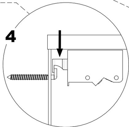
**BE AANDACHT!** Het product moet permanent aan de muur worden bevestigd. Bij gebruik van pinnen kan een gebrek aan bevestiging leiden tot omvallen.
